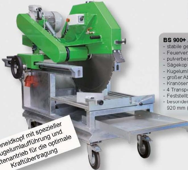
Schneidkopf mit spezieller Kugelumlaufführung und Kettenantrieb für die optimale Kraftübertragung
