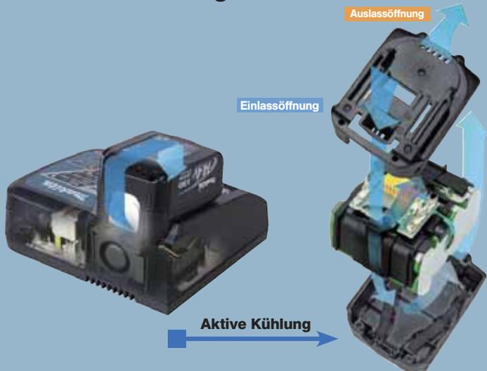
Ein Micro-Chip steuert das Spannungs- und Temperaturverhältnis, damit die Ladegeschwindigkeit nicht auf Kosten der Lebensdauer geht. Ein durchdachtes Akku-Gehäusedesign garantiert die gleichmäßige Kühlung aller Akku-Zellen im Inneren.
