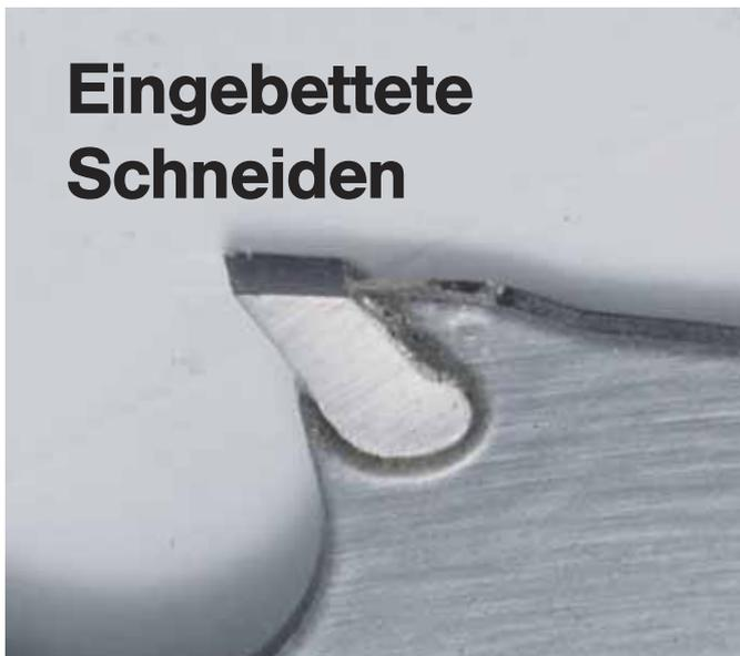
Eingebettete Schneiden verhindern das Ausbrechen der Zähne bei z.B. Nagelrückständen im Werkstück
